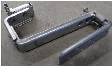
Contrairement aux crochets « Trusshook », les crochets « Universal Hook » sont insérés sur la sous-structure bois sans aucune vis dans le bois : la liaison s'effectue par frottement (ou par pincement).
